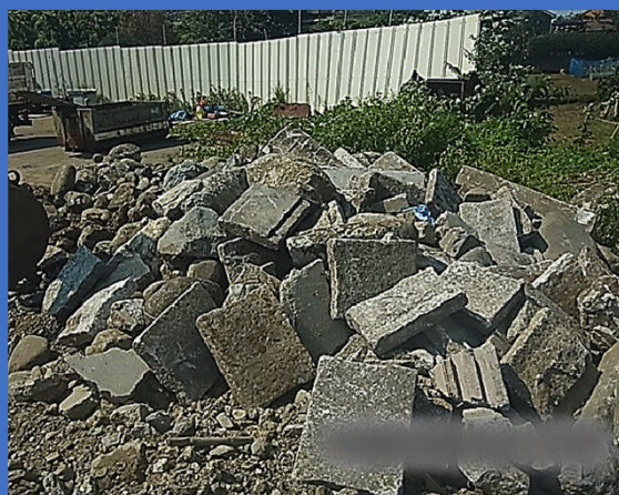
資源化できるコンクリートがら
